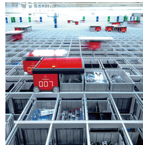
ロボットが入出庫を行うロボットストレージシステム「オートストア」。オカムラが2016年に国内で初導入した。
